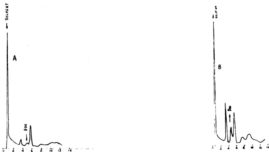
Fig. 3 Cromatogramas obtenidos mediante el análisis por HPLC de los extractos en metanol del producto de la fermentación. (A) cepa salvaje SQF-15, (B) SQF-15 transformada con el plasmidio pCV3. Se utilizó una columna RP 18 y un detector uv a 254 nm. El sistema de solvente utilizado fue metanol:gua (75:25) pH 2 con ácido fosfórico, y un flujo de 2.5 ml/min. dox: doxorubicina.
